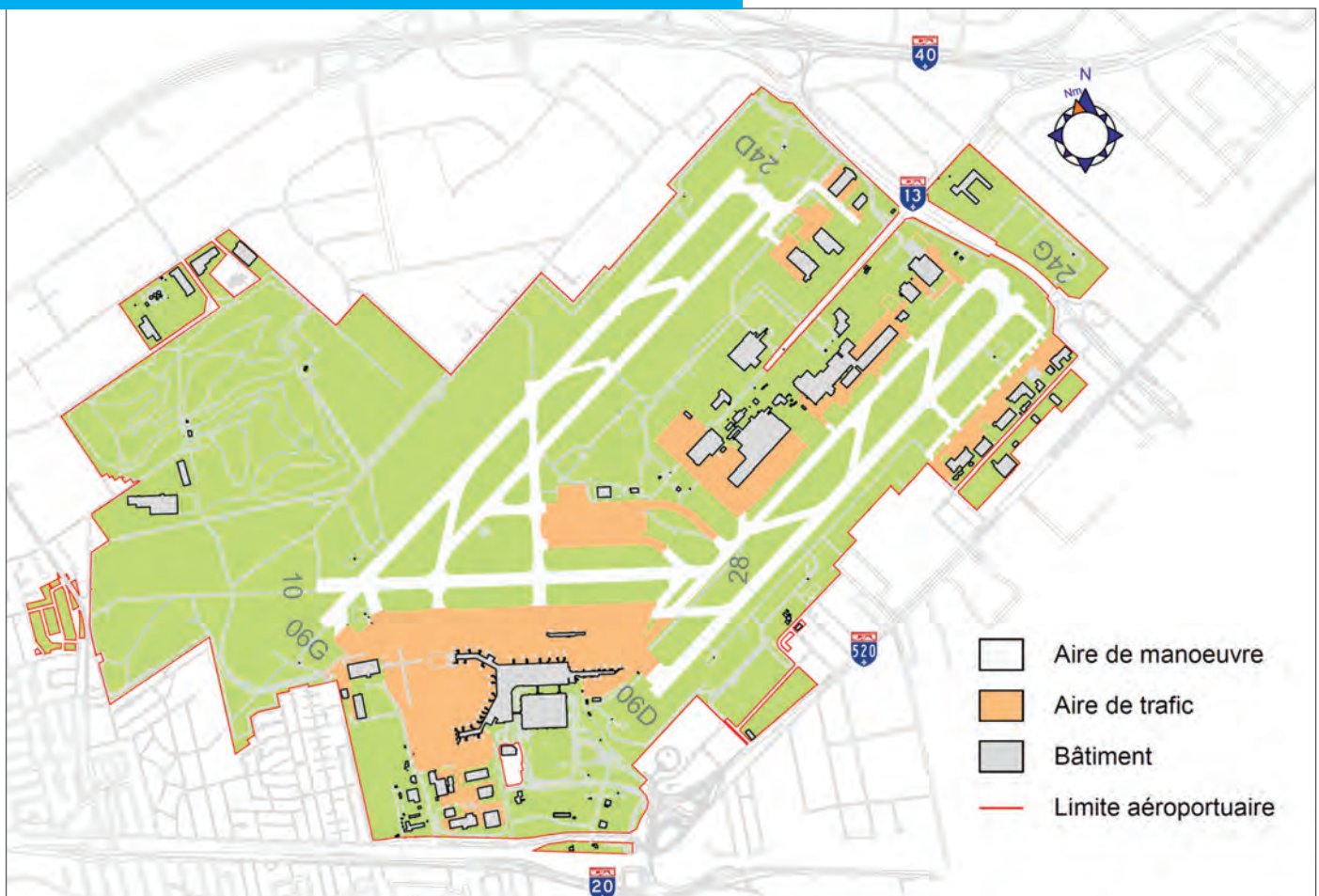
Figure 5.1 : Aire de manœuvre actuelle
