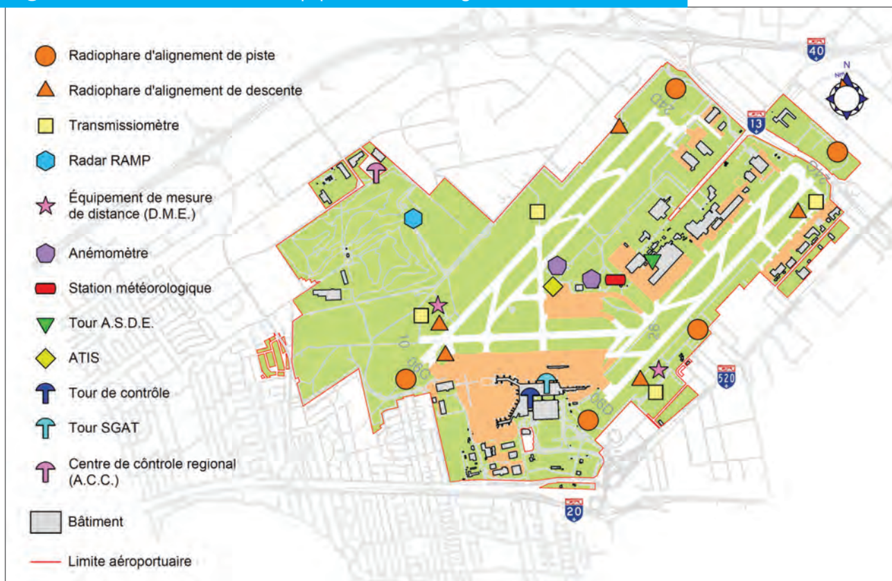
Figure 5.3 : Localisation des équipements de navigation aérienne
